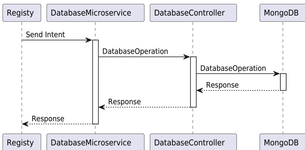
Da dieser Microservice nur eine Route besitzt, über welche der Intent gesendet wird, muss der Microservice dazu in der Lage sein, diesen Intent aufzulösen, sodass die richtige Datenbank-Operation
