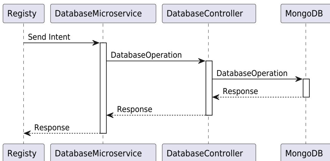
Da dieser Microservice nur eine Route besitzt, über welche der Intent gesendet wird, muss der Microservice dazu in der Lage sein, diesen Intent aufzulösen, sodass die richtige Datenbank-Operation ausgeführt wird. Der Intent kommt ursprünglich von Rasa. Dieser sieht wie folgt aus:
