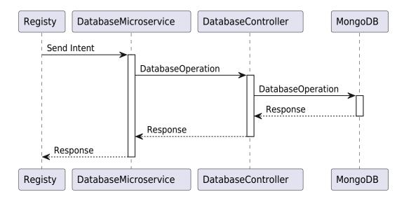
Da dieser Microservice nur eine Route besitzt, über welche der Intent gesendet wird, muss der Microservice dazu in der Lage sein, diesen Intent aufzulösen, sodass die richtige Datenbank-Operation ausgeführt wird. Der Intent kommt ursprünglich von Rasa. Dieser
